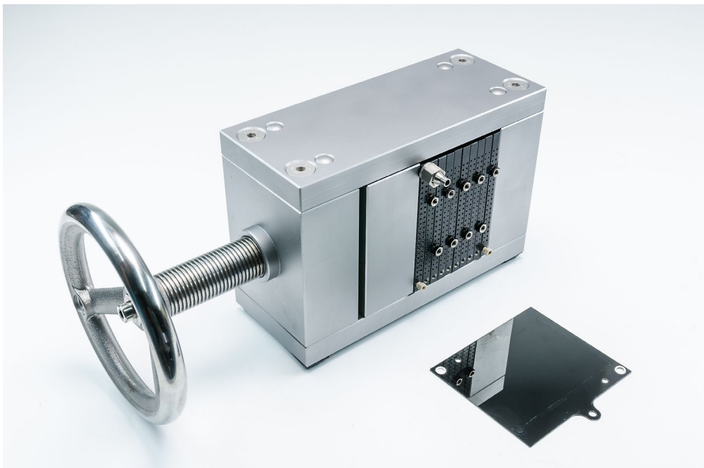
Bild: Flexibler und skalierbarer elektrochemischer Reaktor des Fraunhofer IMM mit 10 Elektrodenplatten, die als Stapelanordnung integriert sind. Im Vordergrund ein weiteres Beispiel für einen Elektrodentyp (flach und unstrukturiert), der in das Reaktorkonzept integriert werden kann. (©Fraunhofer IMM)
