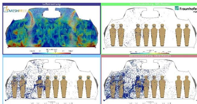
Simulationsszenario Flugzeug – wie verteilen sich Aerosole im Innenraum?
