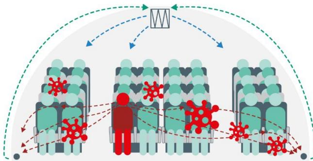
Ein Simulationsszenario: Wie verteilen sich Aerosole in einem Flugzeug?
